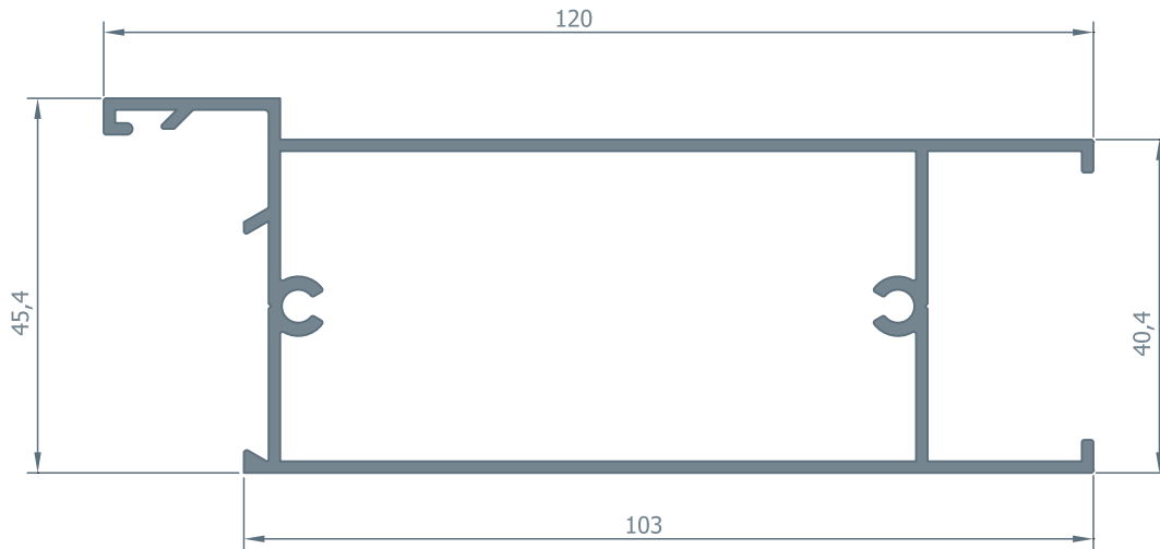
2227 Fugalı Baza Profili 1.315 kg/m
